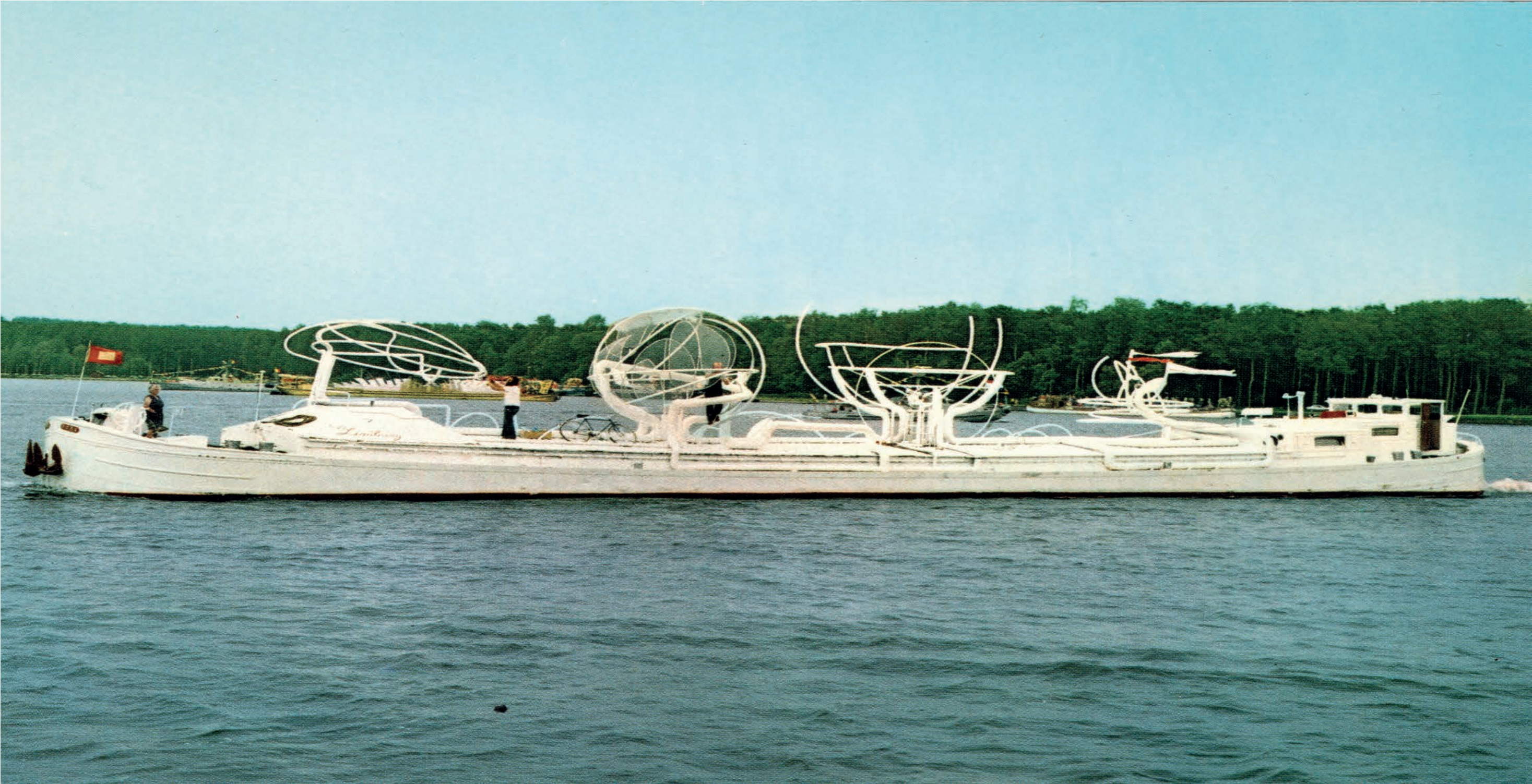
Zoals volledig gevaren op de Maas en de Schelde. Daar sommige bruggen te laag waren om onder door te varen dienden voor symbool wonen metalen delen uitgeklast te worden (tweede van links), voor werken en industrie (derde van links) werd een takelsysteem uitgeroepen om in het ruim af te laten. De schipper van dienst was voor deze periode dus ook techniek.
